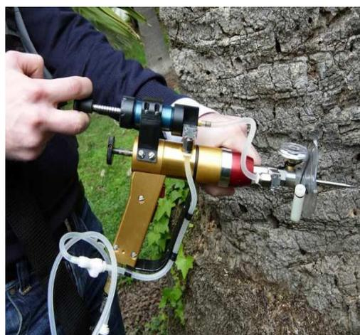
**Fig. 10 - Strumentazione utilizzata per l'endoterapia**
